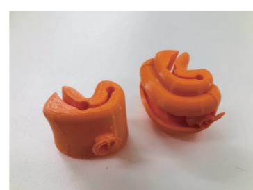
曲げ試験による破断状態
