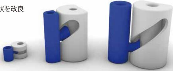
①スリットが水平方向 ②スリットを斜めに (ほぼ完成) ③フィレット追加
