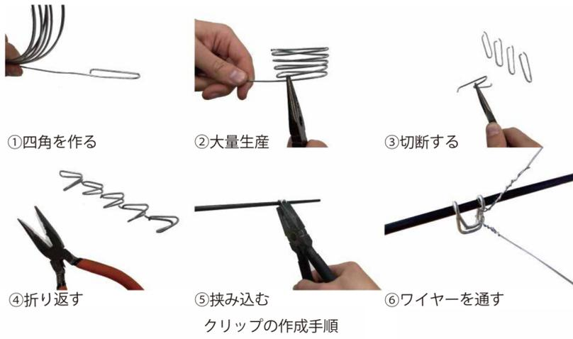
①四角を作る ②大量生産 ③切断する ④折り返す ⑤挟み込む クリップの作成手順 ⑥ワイヤーを通す
