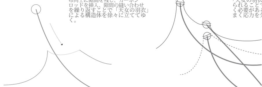
「天女の羽衣」の極薄膜にロッドを挿入するにあたり、布が張られることで張力が均等に分散されるような端部を選んでいく必要がある。張力によって布が破けてしまわないよう、うまく応力を分散できるように端部をずらす。
